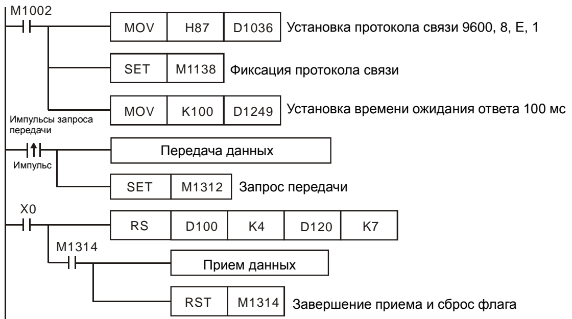
Передача данных: (ПЛК→Внешнее устройство)
