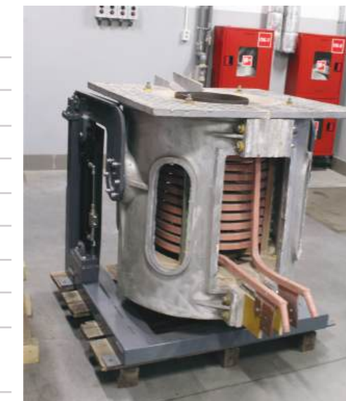
Механизм наклона плавильного узла (гидравлический / электромеханический)
