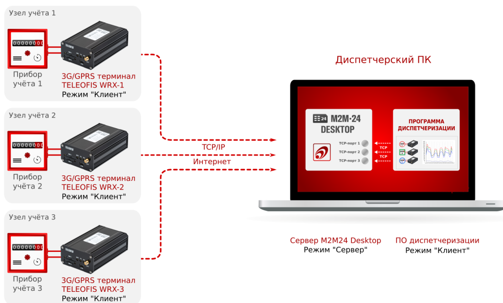
Рис.1. Схема работы сервер M2M24 Desktop.
