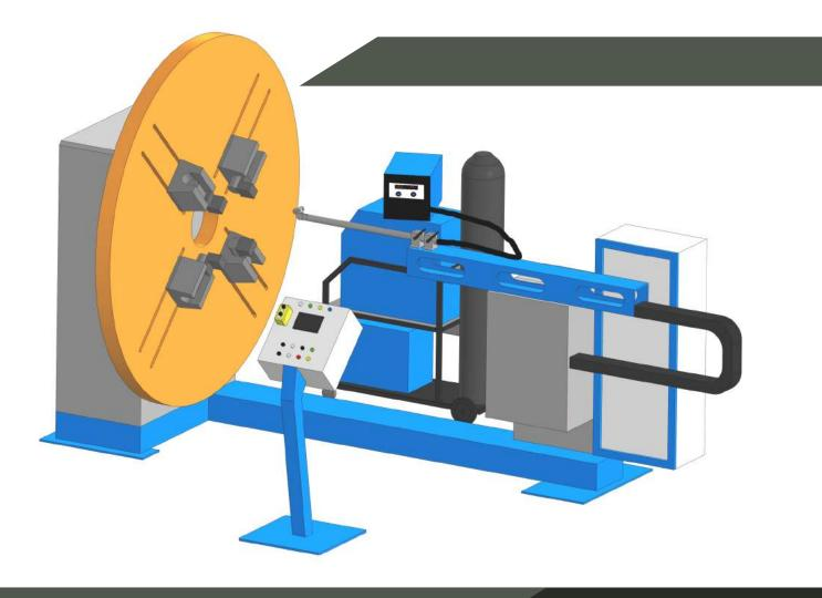
УСТАНОВКА НАПЛАВКИ ТЕЛ ВРАЩЕНИЯ
