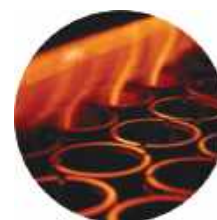
Низко и среднетемпературный отпуск деталей из стали
