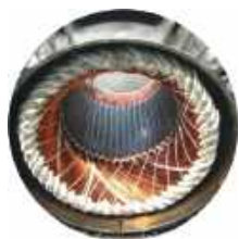
Сушка деталей после покраски и пропитки
