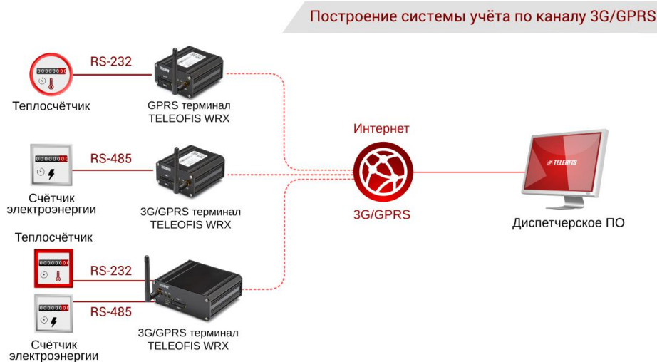
Рис. 2. Построение системы учёта с применением терминалов WRX.
