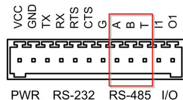
Рис.14. Разъём RS-485 в модемах с двумя интерфейсами.
