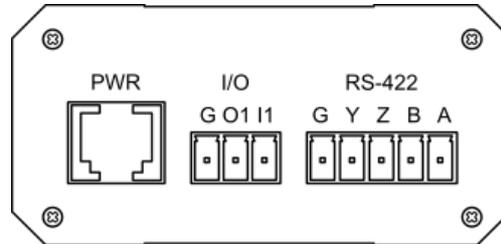
Рис.5. Модемы с интерфейсом RS-422 (металлическое исполнение).
