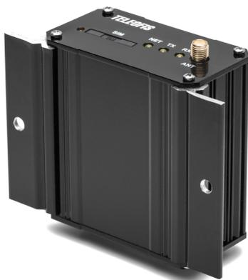
2. **Крепление T:** настенный монтаж на металлическую крепёжную пластину. Модем устанавливается на пластину к стене с помощью двух винтов. Два пластмассовых дюбеля с винтами прилагаются в комплекте.
