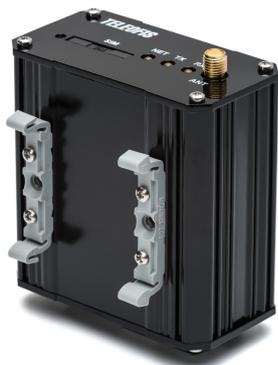
**3. Крепление Н:** монтаж на стандартную DIN-рейку шириной 35 мм с помощью двух пластиковых креплений (кронштейнов). В комплект входят 2 кронштейна и 4 самореза. Для установки модема прикрепите кронштейны с помощью саморезов к отверстиям на корпусе модема (2 самореза на одно крепление).
