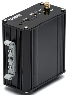
**4. Крепление V:** монтаж на стандартную DIN-рейку шириной 35 мм с помощью одного пластикового крепления (кронштейна) на боковой стороне корпуса. В комплект входят 1 кронштейн и 2 самореза. Чтобы установить модем на DIN-рейку, прикрепите кронштейн с помощью саморезов к отверстиям на корпусе.
