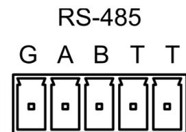
Рис.13. Разъём RS-485.
