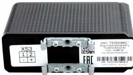
**1. Крепление Н:** монтаж на стандартную DIN-рейку шириной 35 мм с помощью двух пластиковых креплений (кронштейнов). В комплект входят 2 кронштейна и 4 самореза. Для установки модема прикрепите кронштейны с помощью саморезов к отверстиям на корпусе модема (2 самореза на одно крепление).
