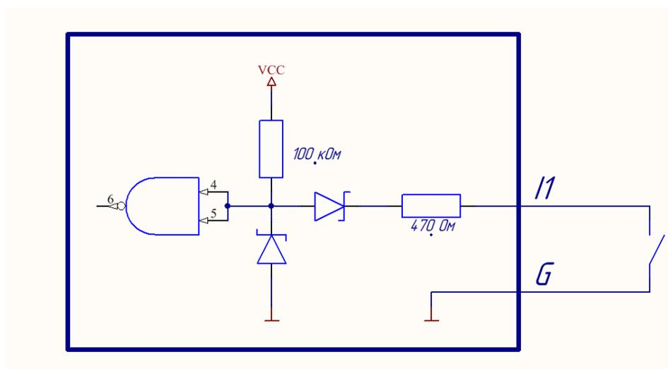
Рис.20. Схема подключения ко входу типа «сухой контакт».
